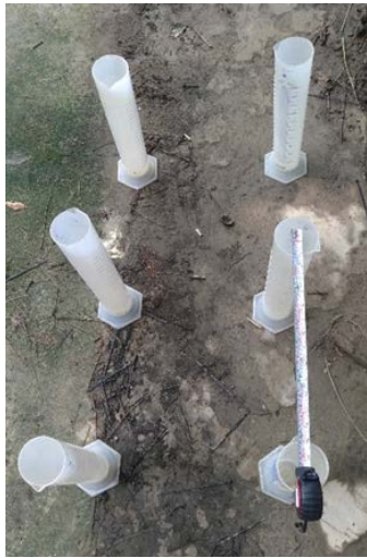
圖 3 降雨強度測試雨量筒擺放
