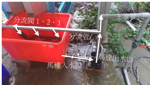
圖 2 人工降雨模擬機-馬達分流管連接情形
